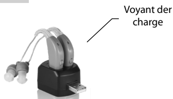
Station d'accueil pour le recharge
